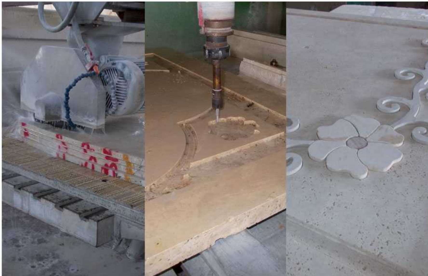
Svuotamento dei ripiani con macchine a controllo numerico
